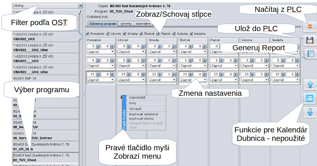
**!** Pozor! Aby sa nezaťažoval riadiaci systém na OST čítaním časových programov. Sú načítané iba raz pri spustení Scada servera. Ak chcete pracovať s časovým programom. Je potrebné pred začiatkom práce stlačiť tlačidlo **Načítaj z PLC** a následne chvíľu počkať. Scada server stiahne aktuálny stav programu z RS a následne vám ho zobrazí...
